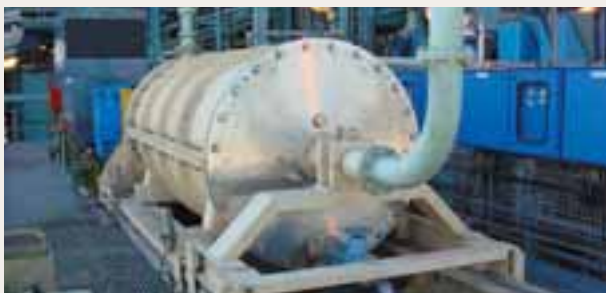
Figura 1: El M3000 IsaMill instalado en Lonmin, Sudáfrica.
